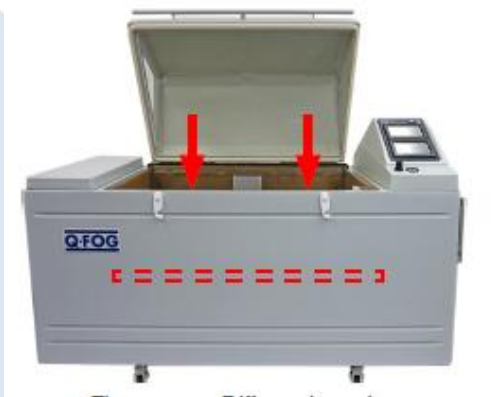
ตำแหน่งจุดวางแผ่นกระจายอากาศภายในห้องทดสอบของเครื่อง
