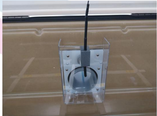
Sensor เซ็นอุณหภูมิภายในห้องเครื่อง (Chamber Temp Sensor)
