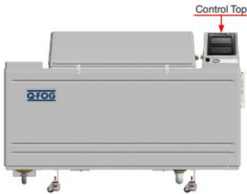
ตำแหน่งชุดควบคุมการทำงานของเครื่อง
