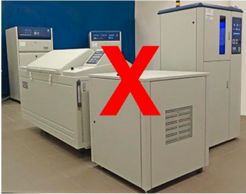
ไม่ติดตั้งรวมกับเครื่อง Q-SUN และ QUV
