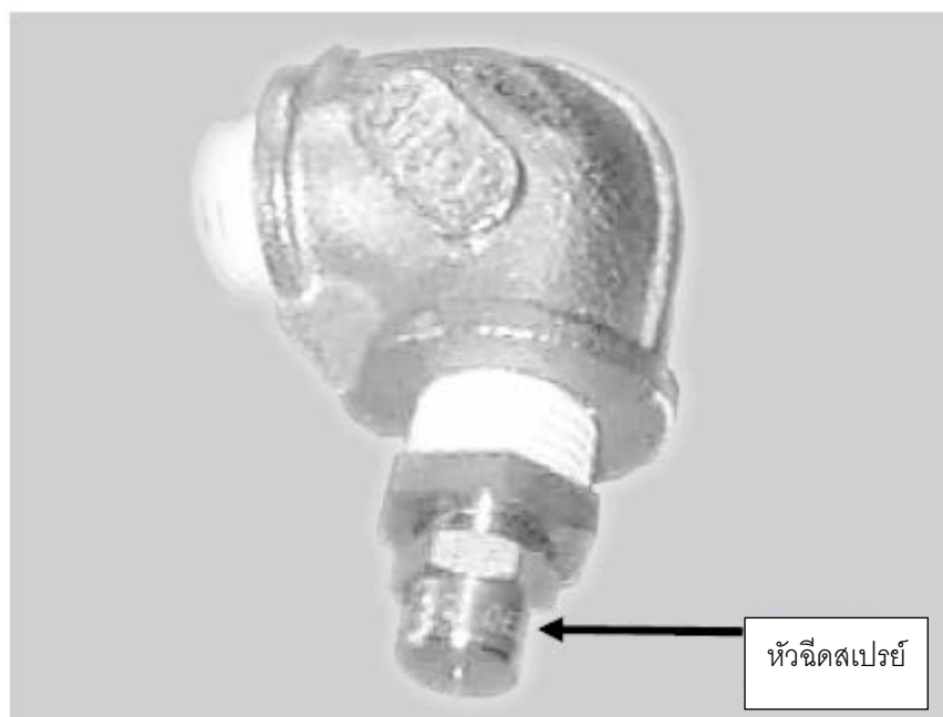
รูปภาพ 5 หัวฉีดสเปรย์ของเครื่อง Q-SUN Xe-1
