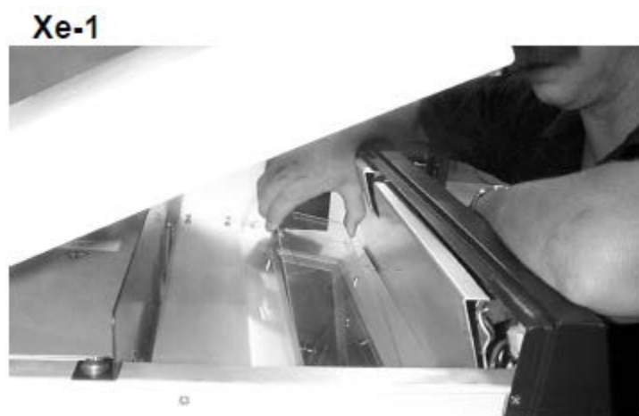
รูปภาพ 8.2 ขั้นตอนการติดตั้งตัวกรองรังสี UV 2
