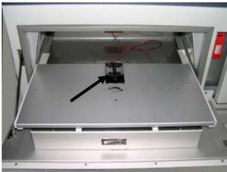
รูปภาพ 6.1 ตำแหน่งการวาง Black Panel ภายในห้องทดสอบชิ้นงาน
