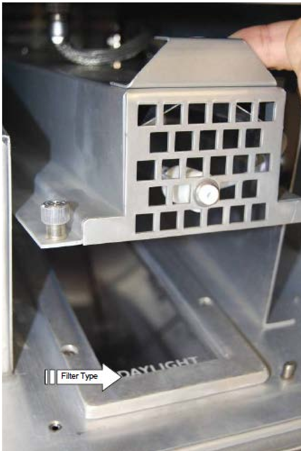
รูปภาพ 8.2 ขกชุด โคมไฟออกจะเห็นตัวกรองรังสี UV
