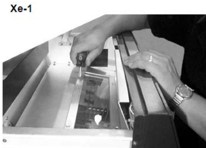
รูปภาพ 8.2 ขั้นตอนการติดตั้งตัวกรองรังสี UV 1
