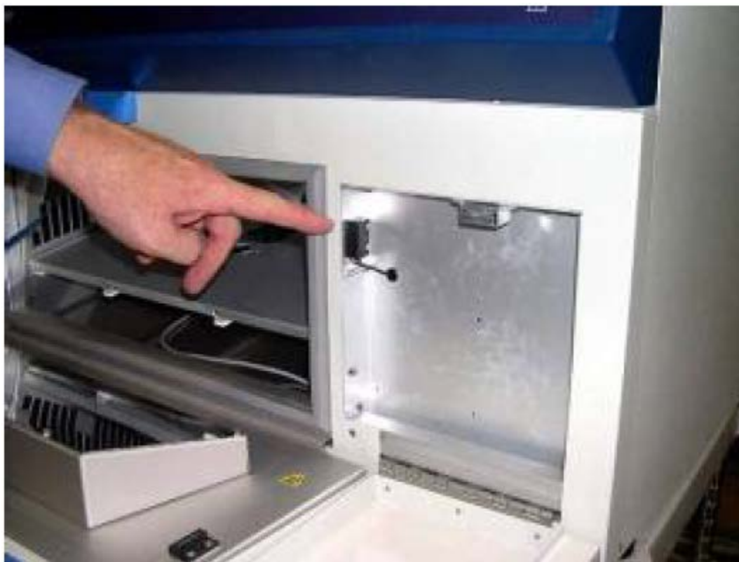
รูปภาพ 1.2 ตำแหน่งสวิตช์ Interlock ภายในประตูห้องทดสอบ
