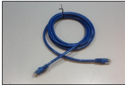
รูปที่ 142. สาย Ethernet
