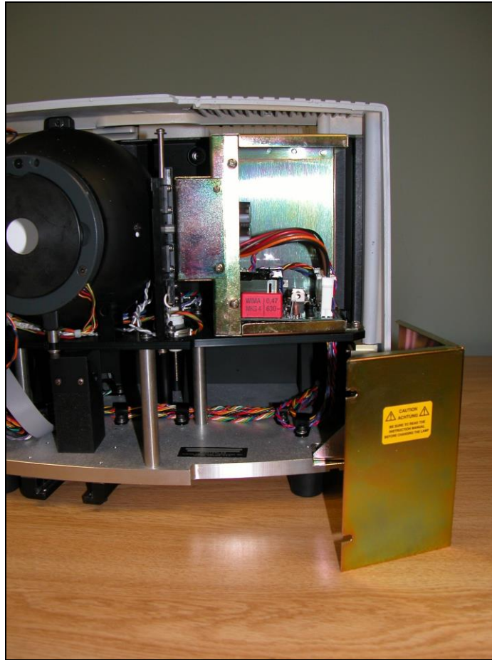
รูปที่ 31. ถอดโครงหลอดไฟ
